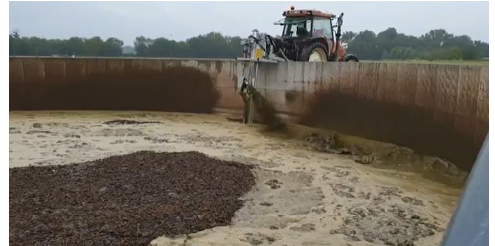
Système de pompage utilisé pour homogénéiser le lisier
