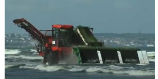
Machine à endive transformée en ramasseuse, TEBO, « Ramassage d'algue verte à la Palud », 1 er juil 2013
